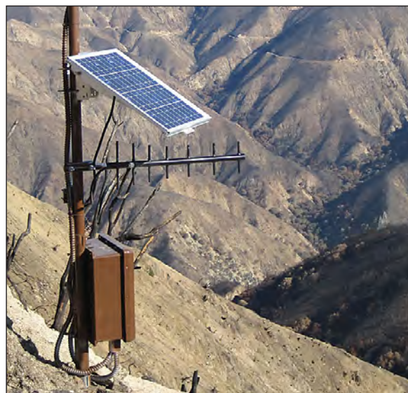
Estación original de lluvia y telemetría establecida después del incendio de “Station” de 2009 en California. Fotografía del Servicio Geológico de los Estados Unidos.
