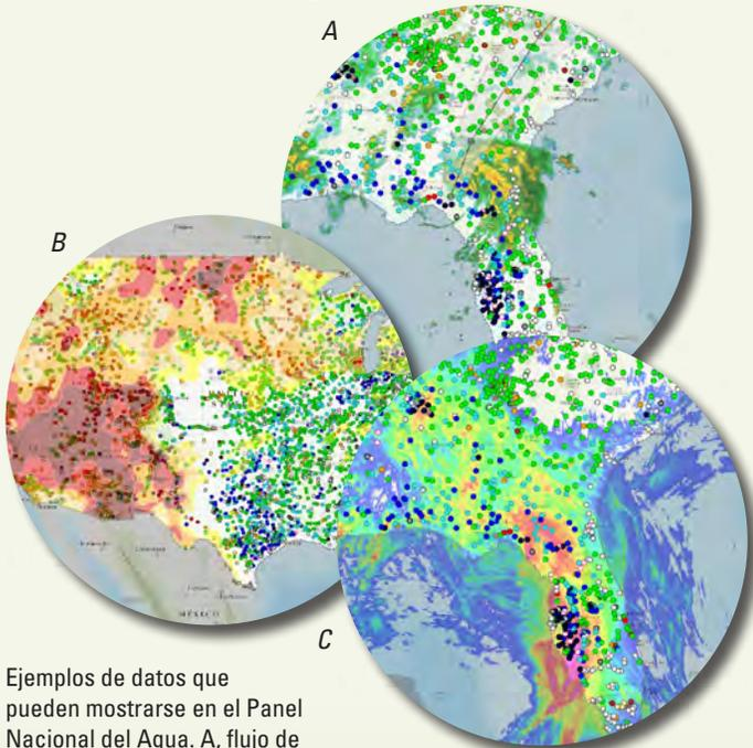
Ejemplos de datos que pueden mostrarse en el Panel Nacional del Agua. A, flujo de agua tras el huracán Elsa (julio de 2021). Los puntos más oscuros reflejan un mayor flujo de agua. B, flujo de agua detectado en los medidores de corrientes de agua, superpuesto con condiciones de sequía. C, precipitaciones en el sureste de los Estados Unidos 24 horas después de que el huracán Elsa tocara tierra en Florida. Los puntos más oscuros reflejan un mayor flujo de agua.
