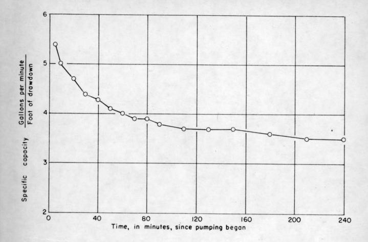
Figure 6.— CHANGE IN SPECIFIC CAPACITY OF WEST SIDE CAMPGROUND TEST WELL (NEV4SEV4SEV4 SEC.24, T.4 N., R.76 W.).
