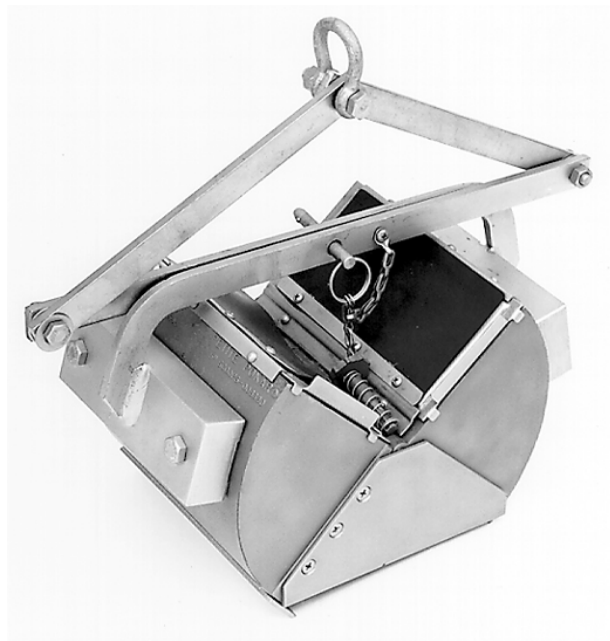
Figure A-9. Ponar Grab Sampler
