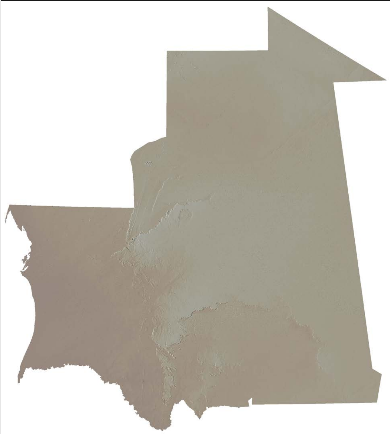
Figure 2. Image en relief colorée du Modèle Numérique de Terrain (MNT) final SRTM de la Mauritanie. Les vides d'origine (trous) ont été remplacés par des données d'altitudes rééchantillonnées ASTER. Les tonalités plus claires sont associées à des altitudes plus élevées.
