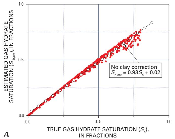
**A** TRUE GAS HYDRATE SATURATION ( $S_h$ ), IN FRACTIONS
